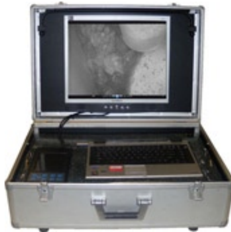
Mobile Tankinspektion über Farbkamerasystem
