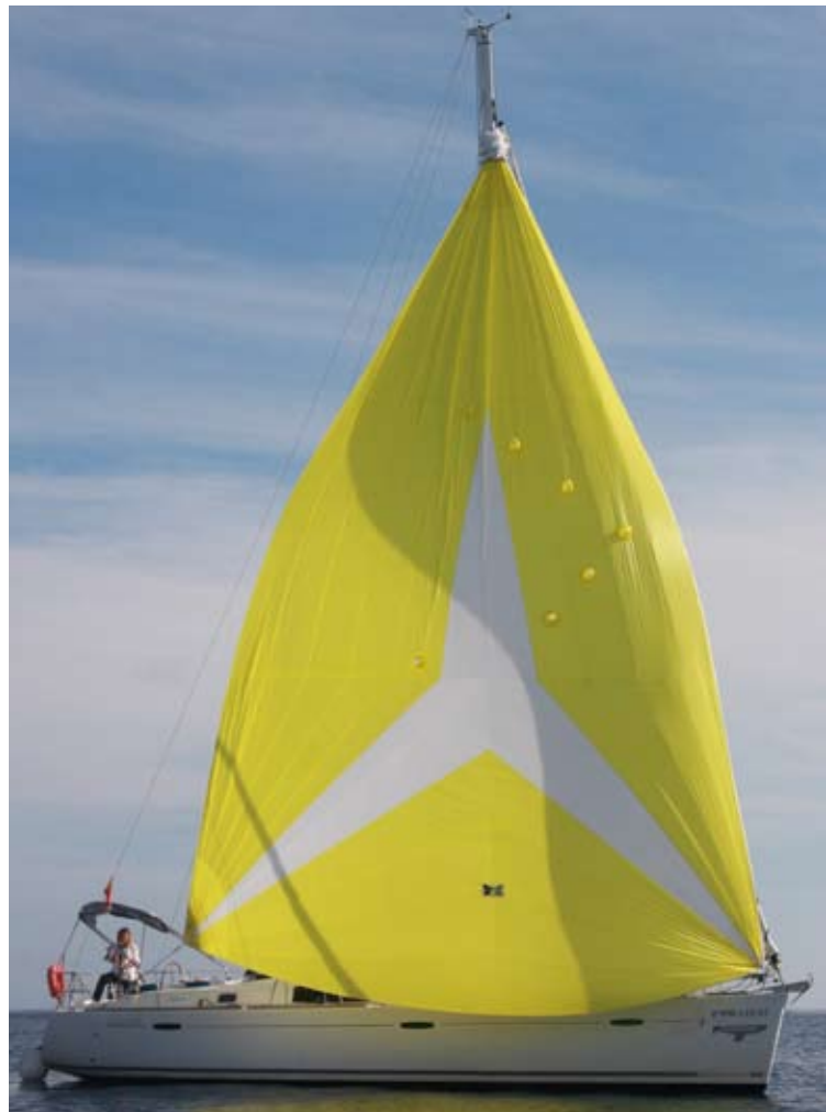
Die Neuentwicklung „Paragen“ der Firma Parasail: Löcher mit Lufthutzen sorgen für einen stabilen Stand. Eine entsprechende Spinnaker-Variante ist ebenfalls verfügbar.
