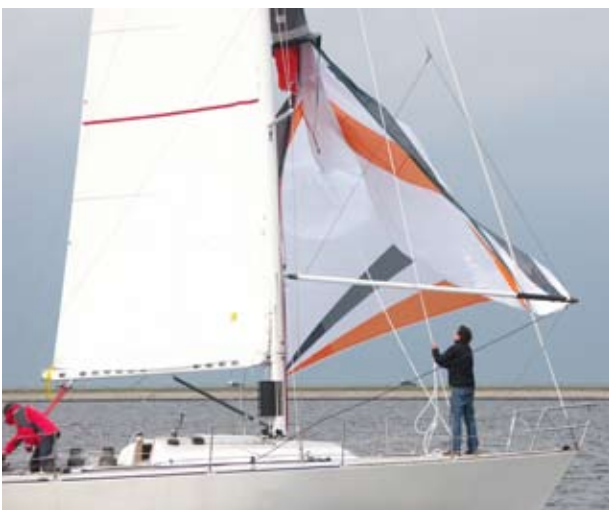
Nachdem der Spibaum angetoppt und die Lose aus den Schoten geholt wurde, wird der Bergeschlauch kontrolliert hochgezogen – das Segel entfaltet sich ohne harte Schläge.
