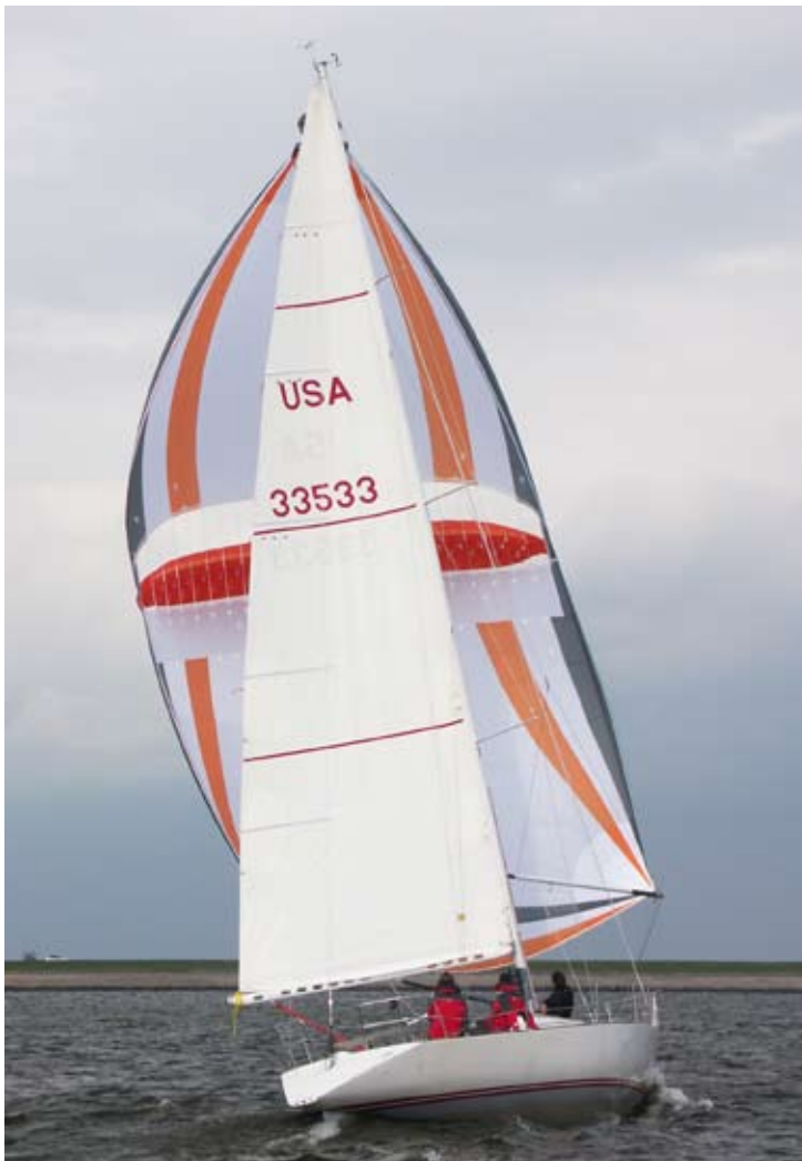
Der „Parasailor“ wird immer aus einem Bergeschlauch gesetzt und kann wie ein konventioneller Spinnaker mit Baum gefahren werden. Der Einsatzbereich reicht von Vorwindkursen bis circa 80 Grad am Wind.
