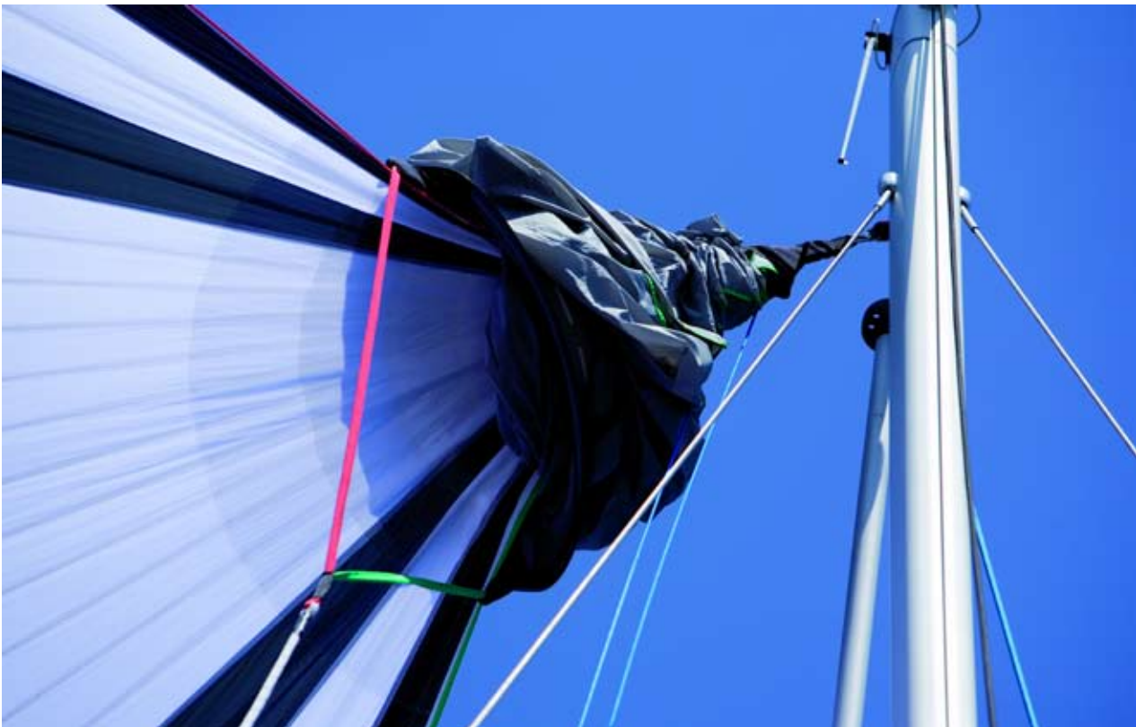
Ein Bergeschlauch vereinfacht das Setzen und Bergen des Spis oder Gennakers und spart so einige Hände an Deck. In diesem Fall sind die Lieken zusätzlich im Trichter geführt und farblich markiert.
