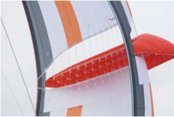
Der dreidimensionale Flügel wird durch den Staudruck der Luft im Segel umströmt und erhält so eine Unterdruckseite, die den „Parasailor“ stabilisiert und für Auftrieb sorgt.
