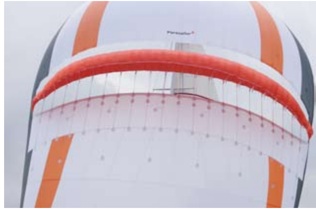
Der Anstellwinkel des Flügels soll Leistungsminderungen aufgrund von Druckverlusten kompensieren. Durch das Flügelgewicht ergeben sich leichte Nachteile bei Schwachwind.
