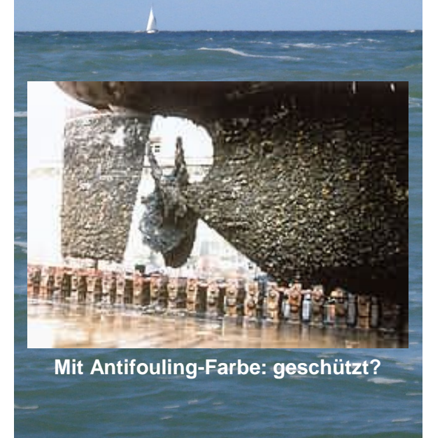
Rumpf mit Harsonic® geschützt, Propeller und Ruder nicht
