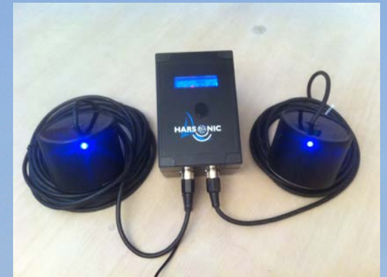
Kontrollbox mit LCD Anzeige und mit 2 Gebern
