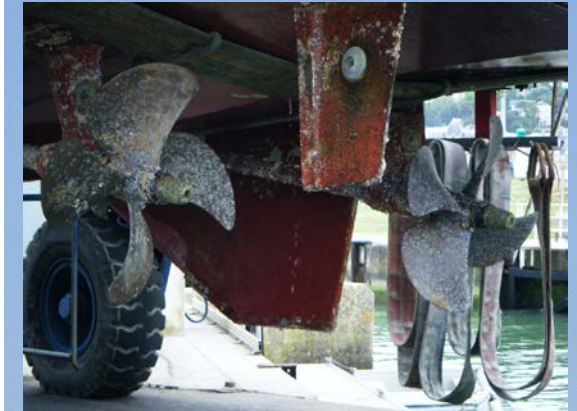
Rumpf mit Harsonic® geschützt, Propeller und Ruder nicht
