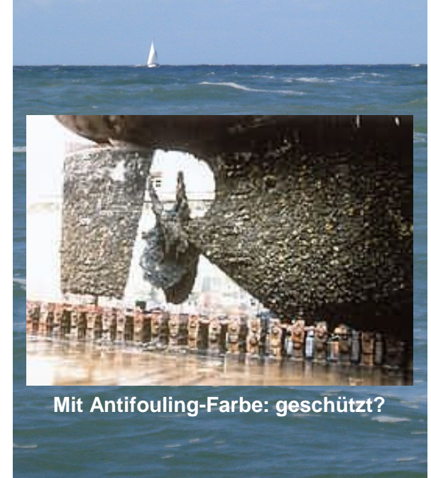
Rumpf mit Harsonic® geschützt, Propeller und Ruder nicht
